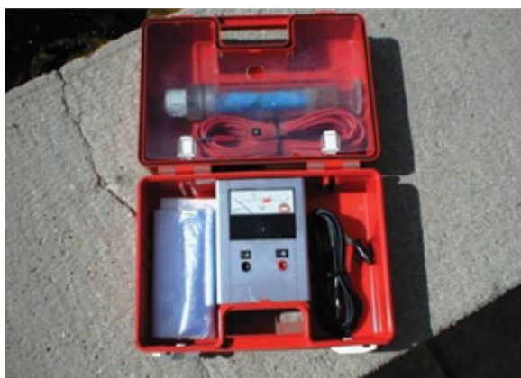
Sa aparatom za mjerenje elektropotencijala možemo jednostavno izmjeriti da li protektori "rade" ili ne.
