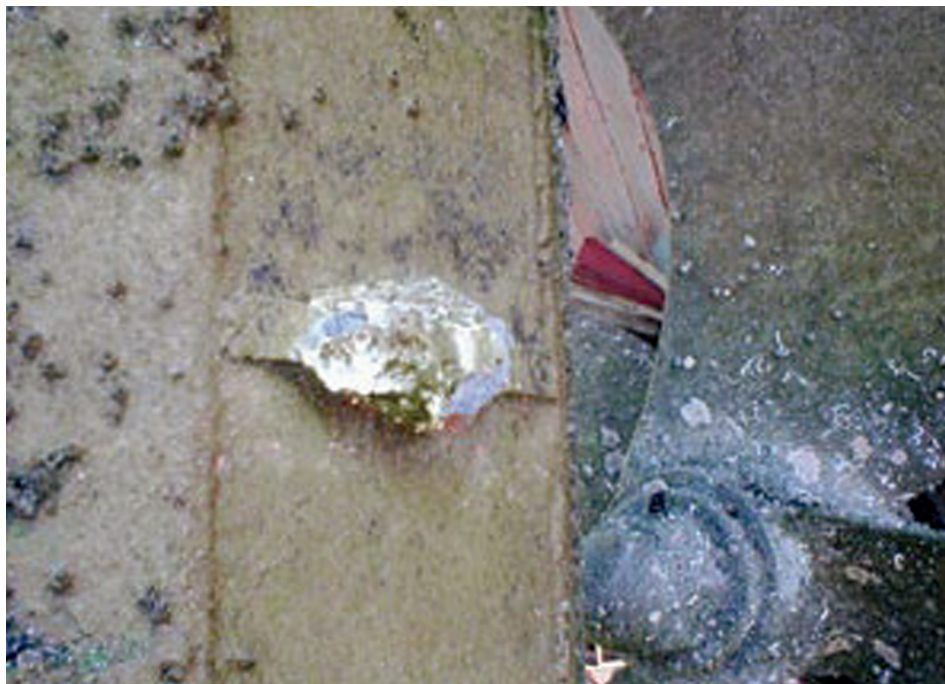
Ovako izgleda potpuno "istrošena" anoda
