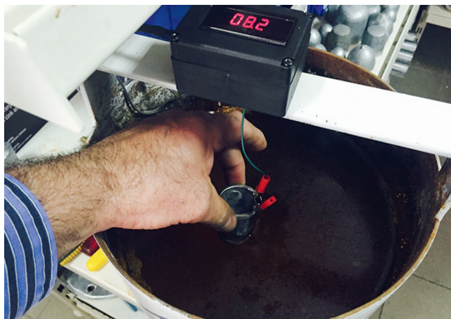
Testiranje efikasnosti anoda u našoj maloprodaji u laboratorijskim uvjetima
