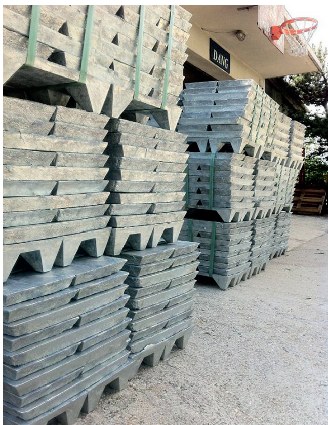
Sirovina spremna za izradu anoda
